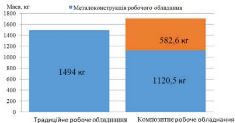
Рис. 8. Порівняння показників традиційного та композитного робочого обладнання бульдозера для одного штовхаючого бруса
